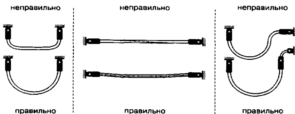
Рис. 17.3. Рекомендации по монтажу гибких трубопроводов
