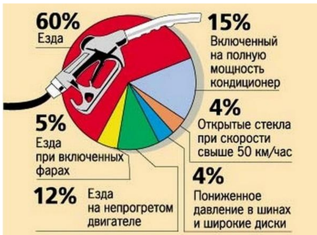
Рисунок 1 – Факторы, увеличивающие расход топлива в автомобиле
