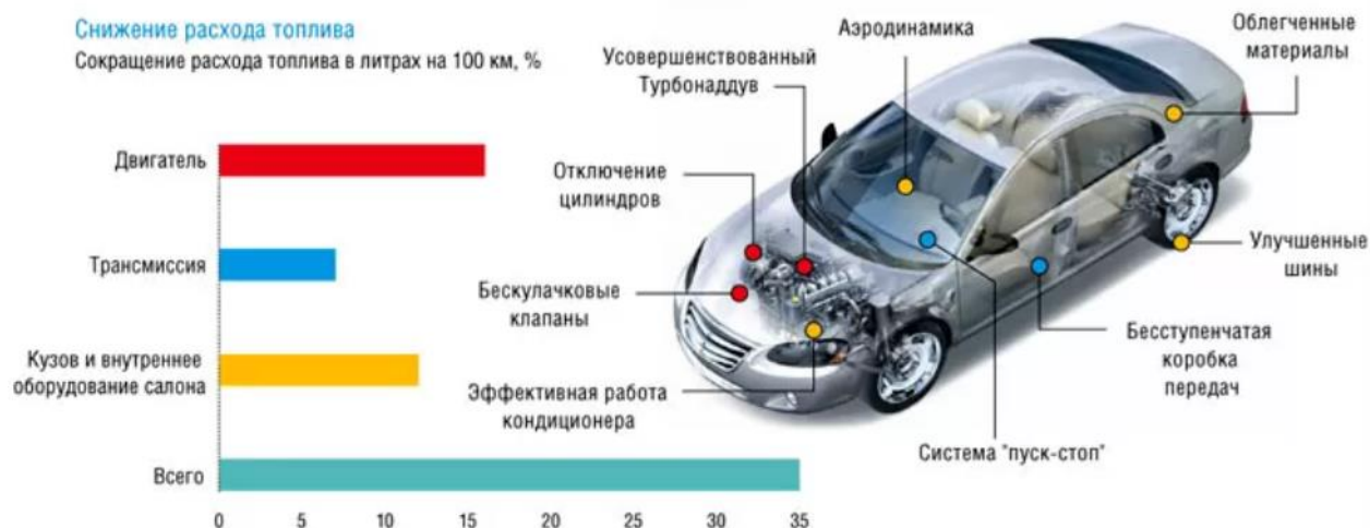
Рисунок 2 – Конструктивные особенности современных автомобилей, предназначенные для снижения расхода топлива
