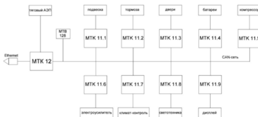
Рис.1 Структурная схема БРСУ электробусом на базе сети контроллеров МТК
