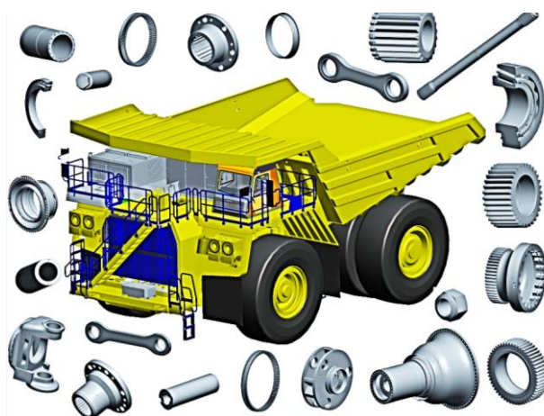
Рисунок 18 – Номенклатура деталей подвески БЕЛАЗ, обрабатываемых на комплексе ФТИ 3.179
