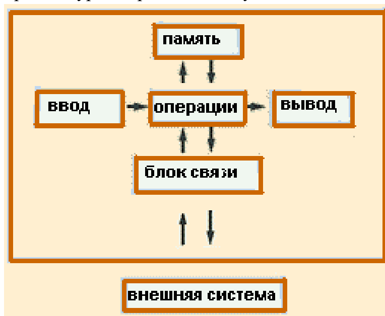
Рисунок 7 – Схема оптического компьютера
