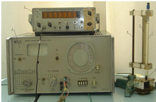
Рисунок 10.3. Внешний вид установки для определения скорости ультразвука в твердом теле и жидкости
