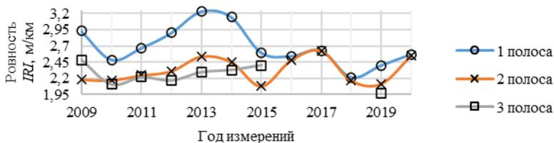
**Рисунок 3 – Пример изменения ровности на автомобильной дороге М-4 Минск – Могилёв (км 17,000, обратное направление)**
