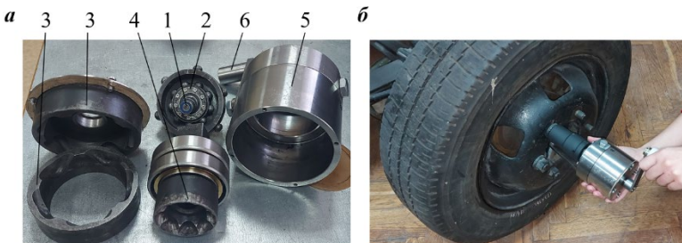
a – основные узлы; б – установка на колесе автомобиля; 1 – ведущий вал с установленным на нем эксцентриком; 2 – спутник; 3 – наружные кулачки; 4 – ведомые вал с кулачком; 5 – корпус; 6 – упор
