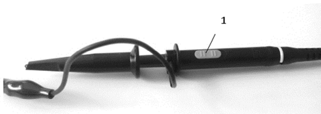
Рис. 2.7. Фото измерительного пробника с переключателем делителя напряжения – 1.
