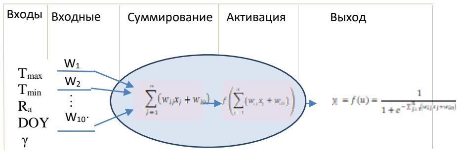
Рис. 1. Структурная схема архитектуры трехслойной ИНС для прогнозирования солнечной инсоляции
