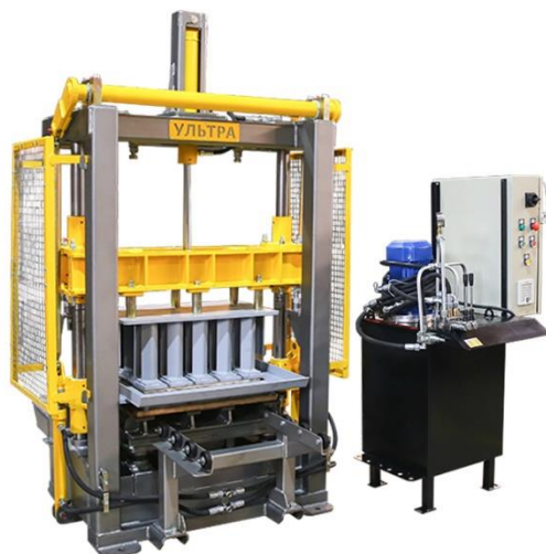
Рис. 1. Общий вид вибропресса.
