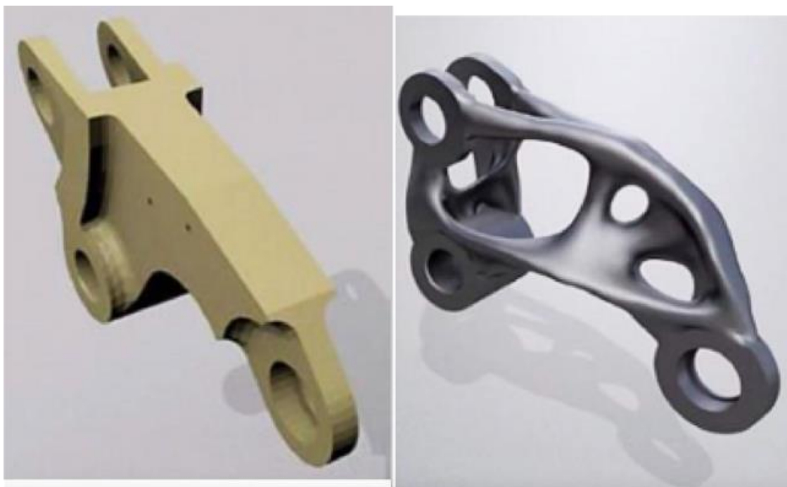
Рис. 2. Топологическая оптимизация детали
