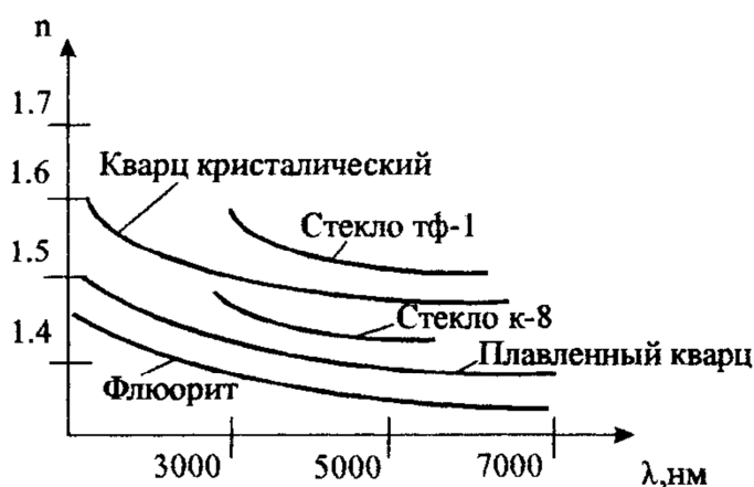
Рис. 7.5. Зависимости показателя преломления стекла от длины волны для оптических стекол разных марок.
