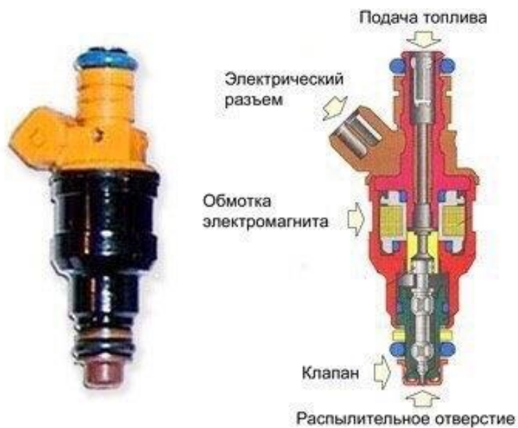
Рисунок 3 – Электромагнитная топливная форсунка
