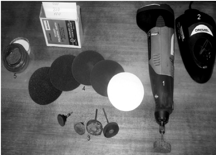
Рис. 1.2. Комплект для пробоподготовки поверхности объектов методом полевой металлографии:
