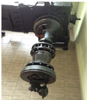
Рис. 3. Лабораторная установка опорно-цепного устройство задних сдвоенных колес трактора БЕЛАРУС класса 50 кН на полуоси трактора
