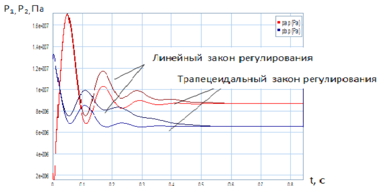
Рис. 5. Графики переходных процессов при K_y=50 для линейного и трапецеидального закона
