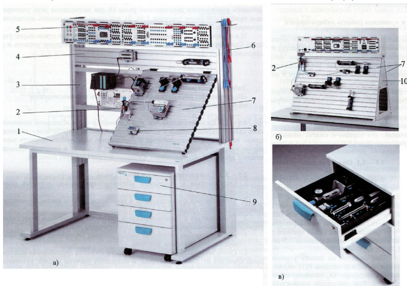
Рис. 1. Общий вид стенда для проведения работ по пневмо- и электропневмоавтоматике
